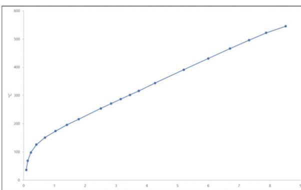
Figure 2: RT (min) vs. BP (°C)
